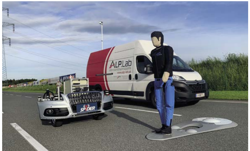
^ Abb. 23 – Mobile HiL Plattform SPIDER bei automatisierten Sensor-Tests mit montierter Fahrzeugfront und Robot-Plattform mit VRU-Target © Gerhard Greiner
