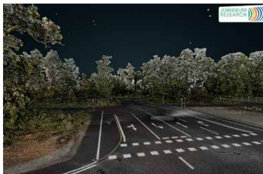
› Abb. 20 – Hochgenaue LiDAR-Punktwolke zur Erstellung von Ultra High Definition (UHD®) Maps, aufgenommen im Testzentrum Digitrans © JOANNEUM RESEARCH Forschungsgesellschaft mbH
