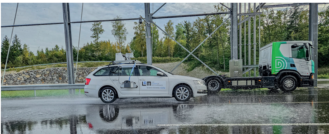
◀ Abb. 10 – Beispielszenario eines erfolgreichen Tests auf der Outdoor-Beregnungsanlage von DigiTrans: Vergleich von stationären Umweltdaten mit einem mobilen Sensorsystem „Mobile Environmental Sensor Rack“ durch das LCM (Linz Center of Mechatronics) © DigiTrans GmbH
