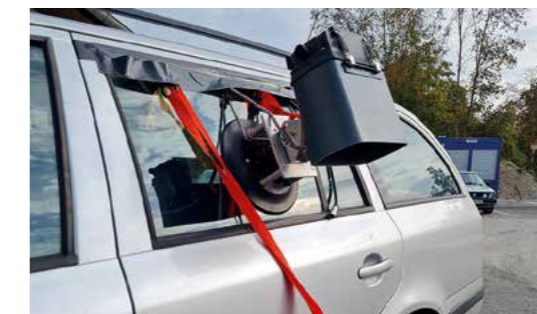
Abbildung 11: Messaufbau für Time-of-Flight-Kamera und Referenzsensor bei den Fahrversuchen in St. Valentin am Digitrans-Gelände © Cornelia Lex
