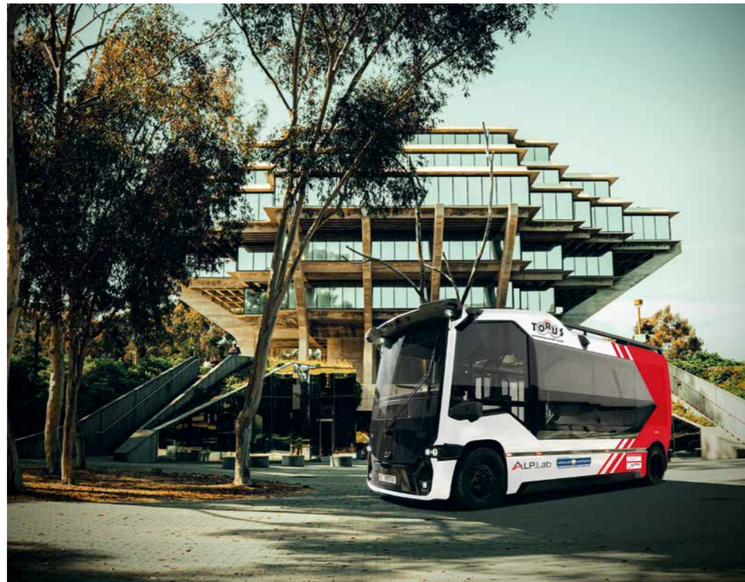
Abbildung 13: Der TORUS Bus – batterieelektrisch und automatisiert als Testträger für Forschung, Mobilitätsbetreiber und Industrie. © ALP.Lab
